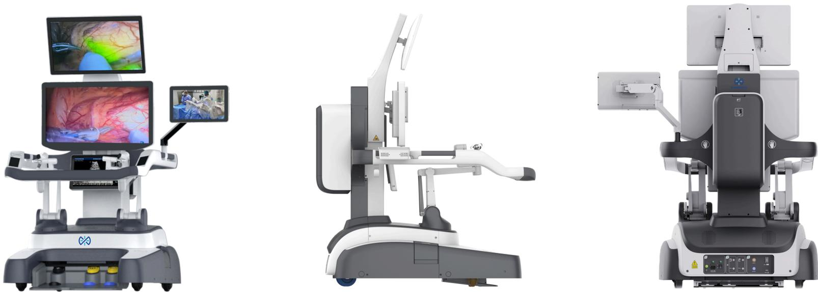
Diseño único e innovador de **consola abierta con 4 pantallas**, el cirujano se sienta frente a la consola y controla todas las acciones de los brazos y cámara mediante dos controles manuales y un conjunto de pedales. Se usa anteojos 3D para observar la pantalla principal, que admite visión **4K (Ultra High Definition) + 3D (Three Dimensional) + ICG (Indocyanine Green)** y puede proporcionar información e íconos de la ubicación quirúrgica y los instrumentos.
